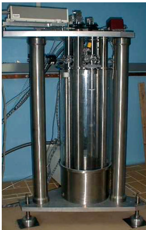
Figura 2. Patrón nacional de presión barométrica por columna de líquido. Manobarómetro.
