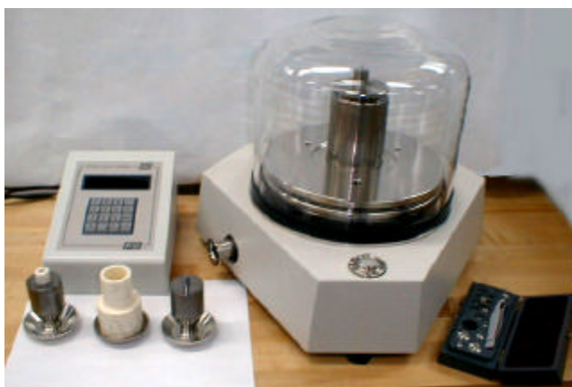
Figura 3. Balanza de presión (patrón primario) preparada para la medición de presión barométrica.
